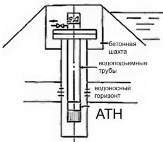
Рисунок 8. Оборудование подруловой напорной скважины
