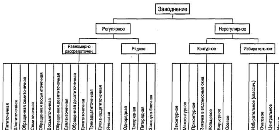
Рисунок 3 - Схема классификации метода заводнения
